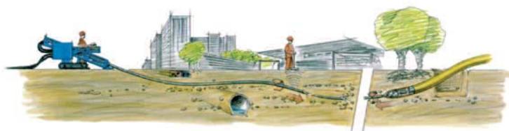
Zanja con colocación simultánea de conductos eléctricos
